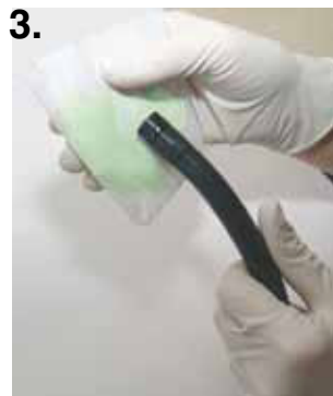
3. Achten Sie auf die sorgsame Reinigung der Linse
